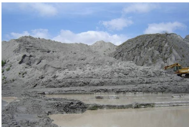
Figura 3 Pilhas de pó de micaxisto gerada no processo de lavagem da brita (ARAÚJO, 2008).
